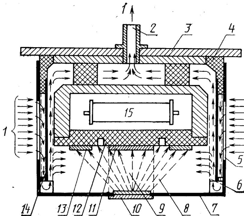
1 — контролируемая среда; 2 — штуцер всасывания контролируемой среды; 3 — основание конструкции; 4 — изолирующее кольцо; 5 — внешняя сетка; 6 — внутренняя сетка; 7 — внешний электрод; 8 — излучение; 9 — измерительный объем; 10 — источник ионизирующего излучения; 11 — измерительный электрод; 12 — изоляционный материал; 13 — охранное кольцо;
